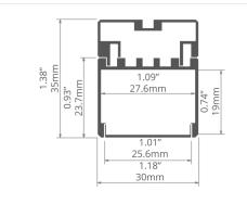
Montageleiste für einfache Montage und Führung von Kabeln.
