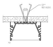
2. Podwieszany sufit Armstronga / Drop ceiling / Befestigung in abgehängter Decke
