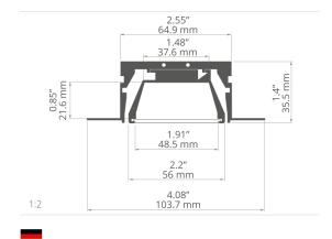
Dank der durchbrochenen Struktur des Montagekanals und seiner einstellbaren Elemente (Brücken) können Netzteile und andere elektronische Geräte in einem beliebigen Bereich der LED-Leuchte versteckt werden, sodass unschöne Revisionsöffnungen in den Decken weitgehend entbehrlich sind.
