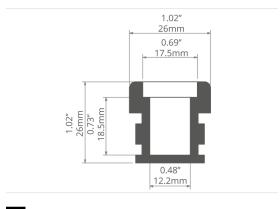
Entwickelt für den Wasserschutz IP67. Beständig gegen Fuss- und Strassenverkehr.
