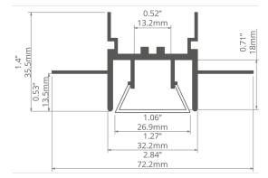
Verbindet mehrere Funktionen: Leuchte, Gestell für die Spanndecke, Gestell für die Hängedecke aus Gipskarton. Kompatibel mit den standardmässigen Befestigungen der Hängedecken.
