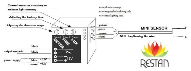
Install a mini sensor - connect "only" wire:
