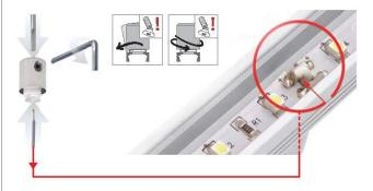
sposób podłączenia jednego z biegunów paska LED przy zastosowaniu zawieszki typu ZO example of the connection of one of the LED strip poles with the use of a ZO fastener Beispiel für die Verbindung eines LED Band Poles mit Hilfe der ZO Befestigung
