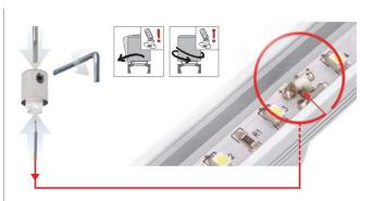
sposób podłączenia jednego z biegunów paska LED przy zastosowaniu zawieszki typu ZO example of the connection of one of the LED strip poles with the use of a ZO fastener Beispiel für die Verbindung eines LED Band Poles mit Hilfe der ZO Befestigung
